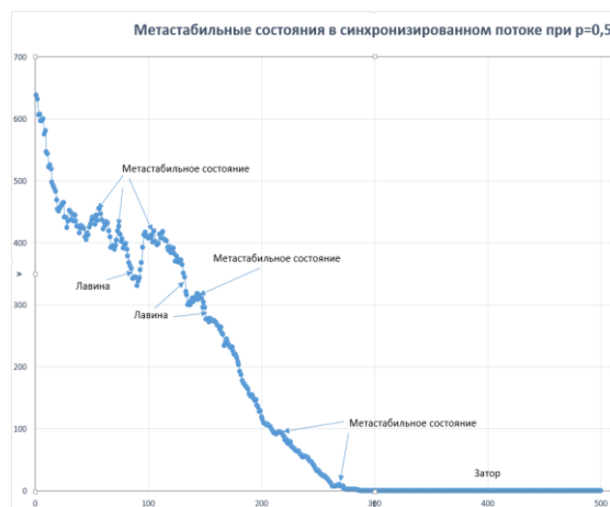
Рисунок 9 – Метаустойчивые состояния в синхронизированном потоке при p=0,5
