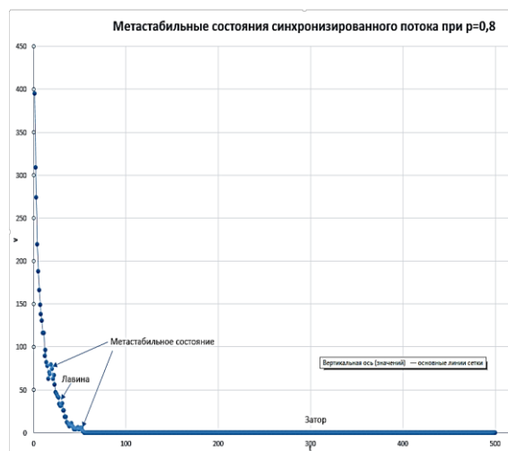
Рисунок 15 – Метастабильные состояния в синхронизированном потоке при \rho=0,8
