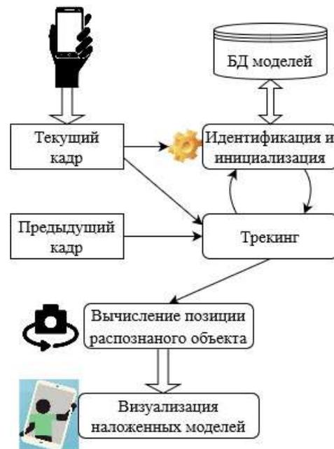
Рисунок 3 – Общий алгоритм для создания AR-приложения на базе пространственных или бемаркерных технологий
