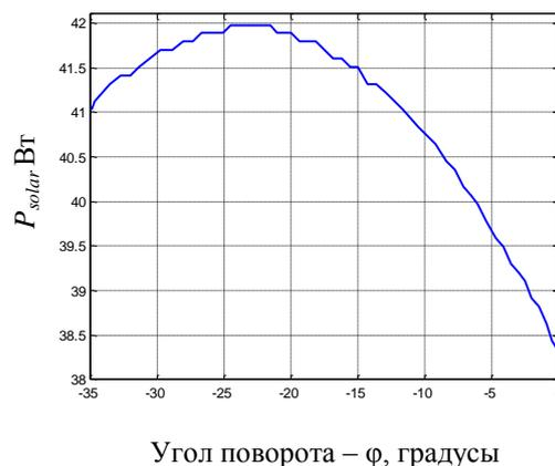
Рисунок 9 - График зависимости мощности модуля от угла его поворота
