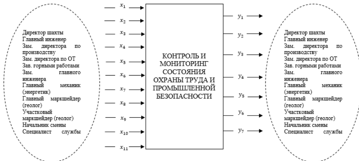
Рисунок 3 – Модель «черный ящик» системы «Контроль и мониторинг состояния охраны труда и промышленной безопасности»
