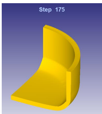
Рисунок 10 – Результат формоизменения изделия из свинца
