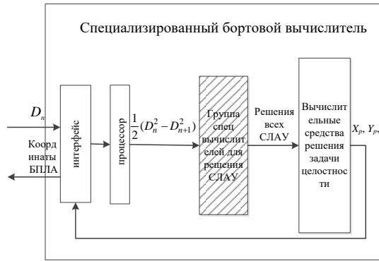
3 4 Рисунок 1 - Увеличенная структурная схема специализированного бортового вычислителя.
