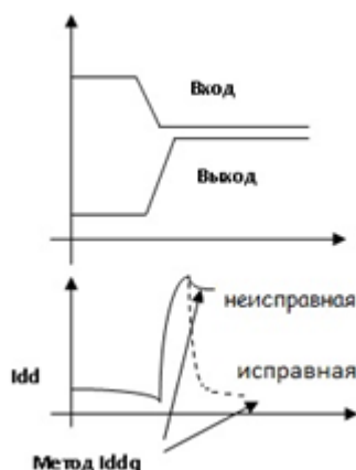
Рисунок –14. Ток в исправной и неисправной схемах.
