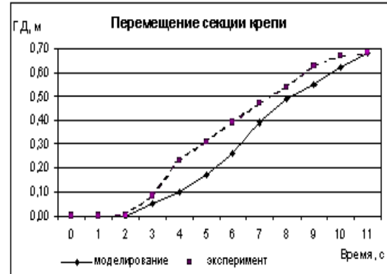
Рисунок 3 – Перемещение секций крепи
